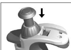
6. 再次将红色调节滑块向外侧推，向下推动量程调节旋钮，再松开调节滑块。重新插入保护盖。
